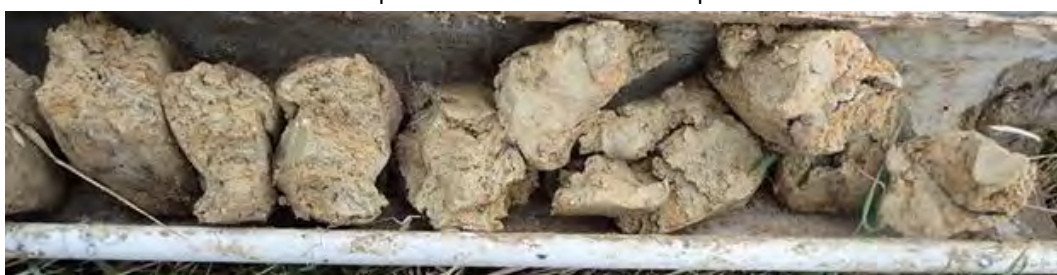
Échantillon prélevé entre 80 à 120 cm de profondeur
