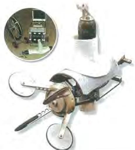
de type amiante-ciment ou fonte, qui sont des matériaux poreux sur lesquels la manchette va bien adhérer. Le PVC par contre est un matériau plus « lisse » qu'il va falloir fraiser avant la pose de la manchette pour permettre une meilleure adhérence de celle-ci.
