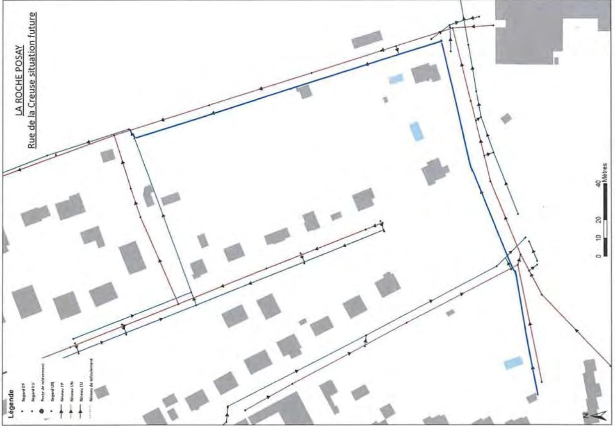
La surface raccordée à ce réseau avoisine les 2.3 ha, même si une grande partie des eaux pluviales est écrêtée par le déversoir d'orage, une réduction non négligeable de la collecte d'eaux pluviales peut être attendue suite aux travaux de déconnexion. Cette réduction est d'autant plus intéressante qu'elle intervient en amont d'un poste de relèvement, le PR Mac O'Neil (ou stade).
